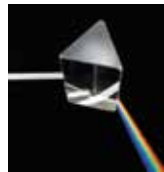
شکل ۲۲-۱۴ الف) پاشندگی نور سفید در منشور ب) رنگ‌های تشکیل‌دهنده طیف نور سفید
